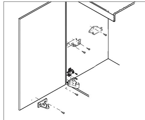
**NOTA:** Debe verificar que la posición de la base para bisagra inferior, no interfiera con la colocación del enganche inferior del bote para basura y esto pueda evitar la rotación libre de la puerta.
